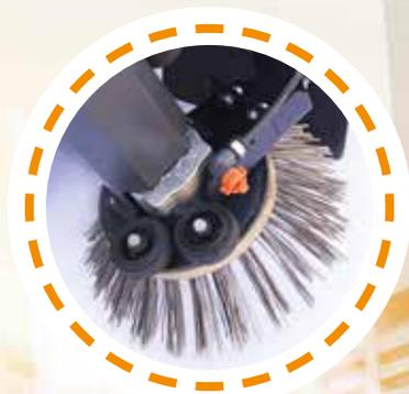
Sistema raschiante laterale con spazzola rotante aggiuntiva in acciaio per diserbaggio marciapiedi
