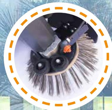
Sistema raschiante laterale con spazzola rotante aggiuntiva in acciaio per diserbaggio marciapiedi
