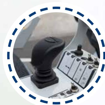
Sistema di avanzamento steer by wire controllato da joystick ergonomico posto su bracciolo destro
