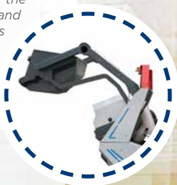
Sistema di scarico rifiuti posteriore a 1500 mm di altezza e contenitore rifiuti da 220 litri di volume.
